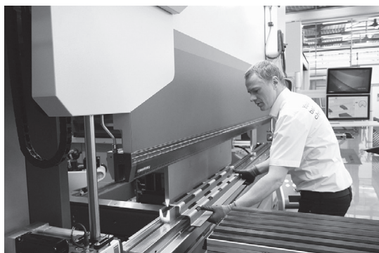
写真2 サイズの違う長穴のあるワークを使った曲げ加工のデモンストレーション
