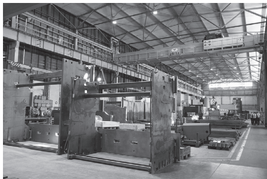
写真 5 できたばかりのプレスブレーキのフレーム。分厚い鋼板としっかりした溶接から、剛性が高い理由が伺えた
