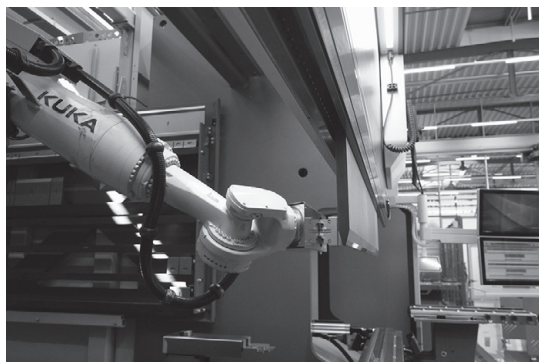
写真4 ロボットアームがラックから金型を取り出してホルダに取り付ける
