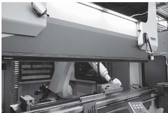
写真3 プレスブレーキの内部に金型交換を行う6軸ロボットと金型ストックがある
