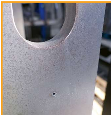
Perçage de 4 mm de diamètre réalisé avec le ByStar 12 kW chez Thievin.
