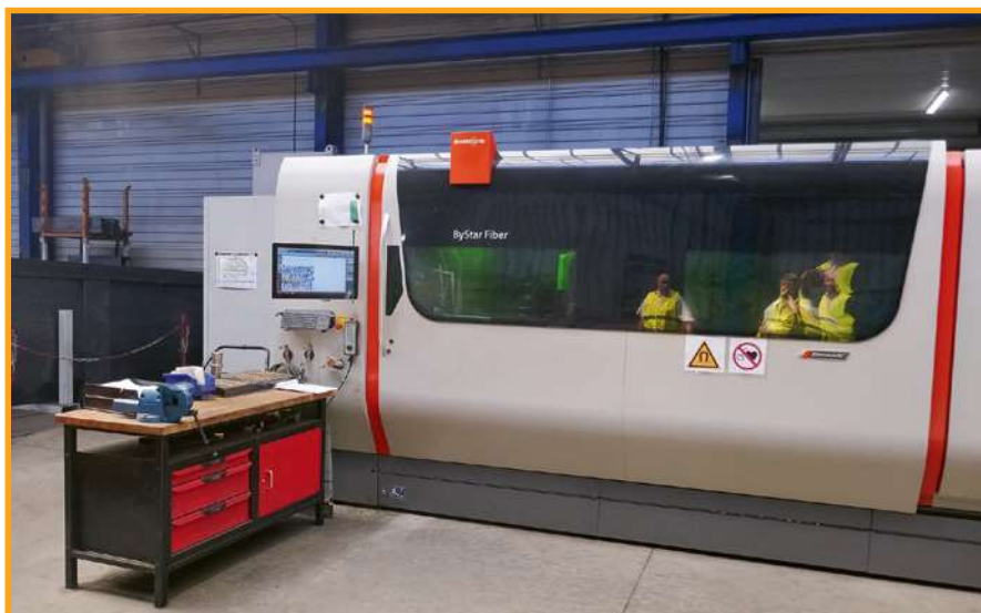
Centre de découpe ByStar au format 4x2 m doté d'une source laser fibre de 12 kW, raccordée à une tour de stockage de 46 palettes, et d'un système de tri cartésien.
