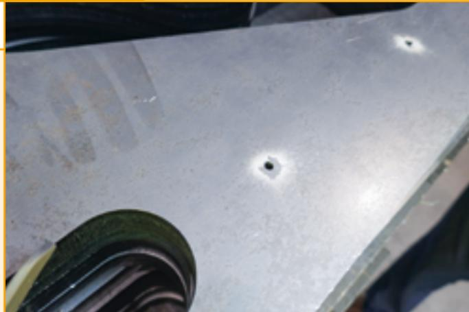
Grâce à la forte puissance, le perçage de la tôle est beaucoup plus rapide, ce qui minimise les problèmes de chauffe et permet de réaliser le perçage avec des ratios diamètre/épaisseur très inférieurs à 1.
