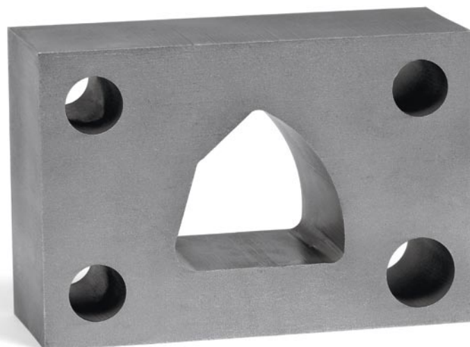
Изготовление форм и инструментов Матрица штампа 90 мм, высоколегированная инструментальная сталь
