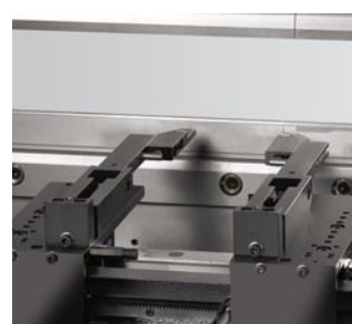
형식 X, R: 2 DNC-제어식 축. 양쪽 핑거는 Z-방향으로 측면에서 수동으로 조정할 수 있습니다.
