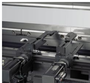
Type X, R, Z1, Z2: 4 axes pilotés par la DNC.
