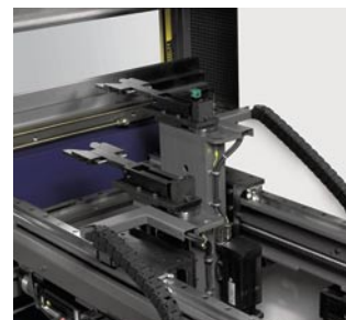
Type X1, X2, R1, R2, Z1, Z2: 6 axes pilotés par la DNC.
