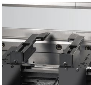
Type X, R: 2 axes pilotés par la DNC; Z manuel.
