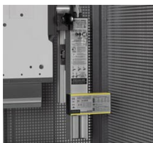
Dispositif de sécurité Protection opérateur par faisceau laser.
